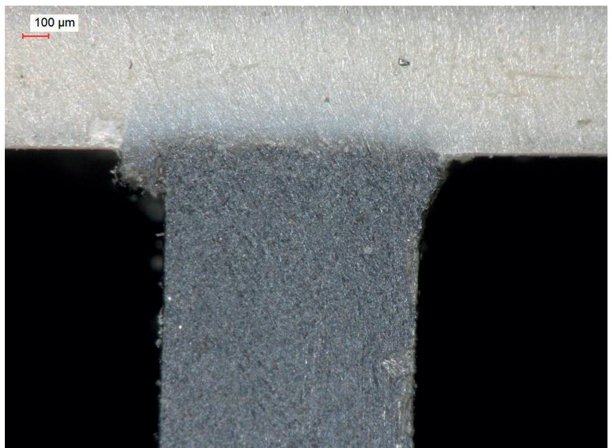
Querschnitt einer Fügenaht: Der Schriff quer zur Nahrichtung zeigt eine Fügezone und charakteristischen Schmelzaustrieb für das Quasi-Simultanschweißen © Evosys, DIC
